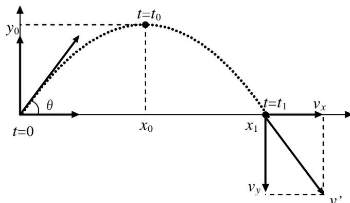
図 11.2 斜方投射する物体の速度
